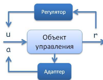
Рисунок 1. Дополнительный контур обратной связи в системе адаптивного управления
